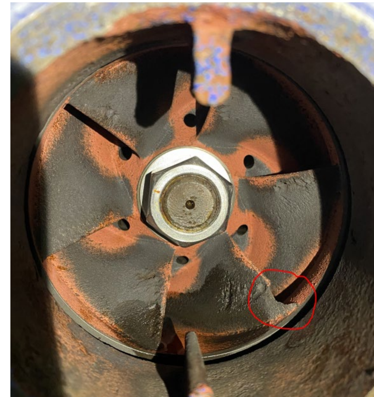
Abbildung 3: Pumpe mit defektem Laufrad samt ausgebrochener Lamelle
